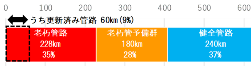
南九州市 \phi 50\text{mm} 以上の老朽管路の状況
