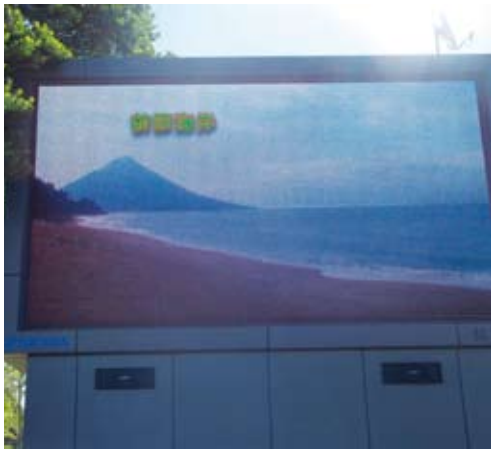
青色発光ダイオードを使用した電光掲示板
