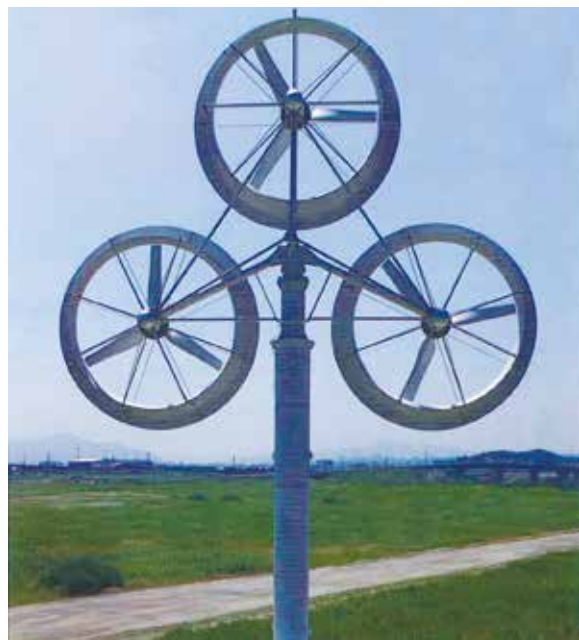
レンズ風車型の風力発電施設
