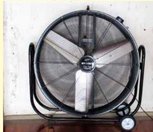
大型循環送風機
