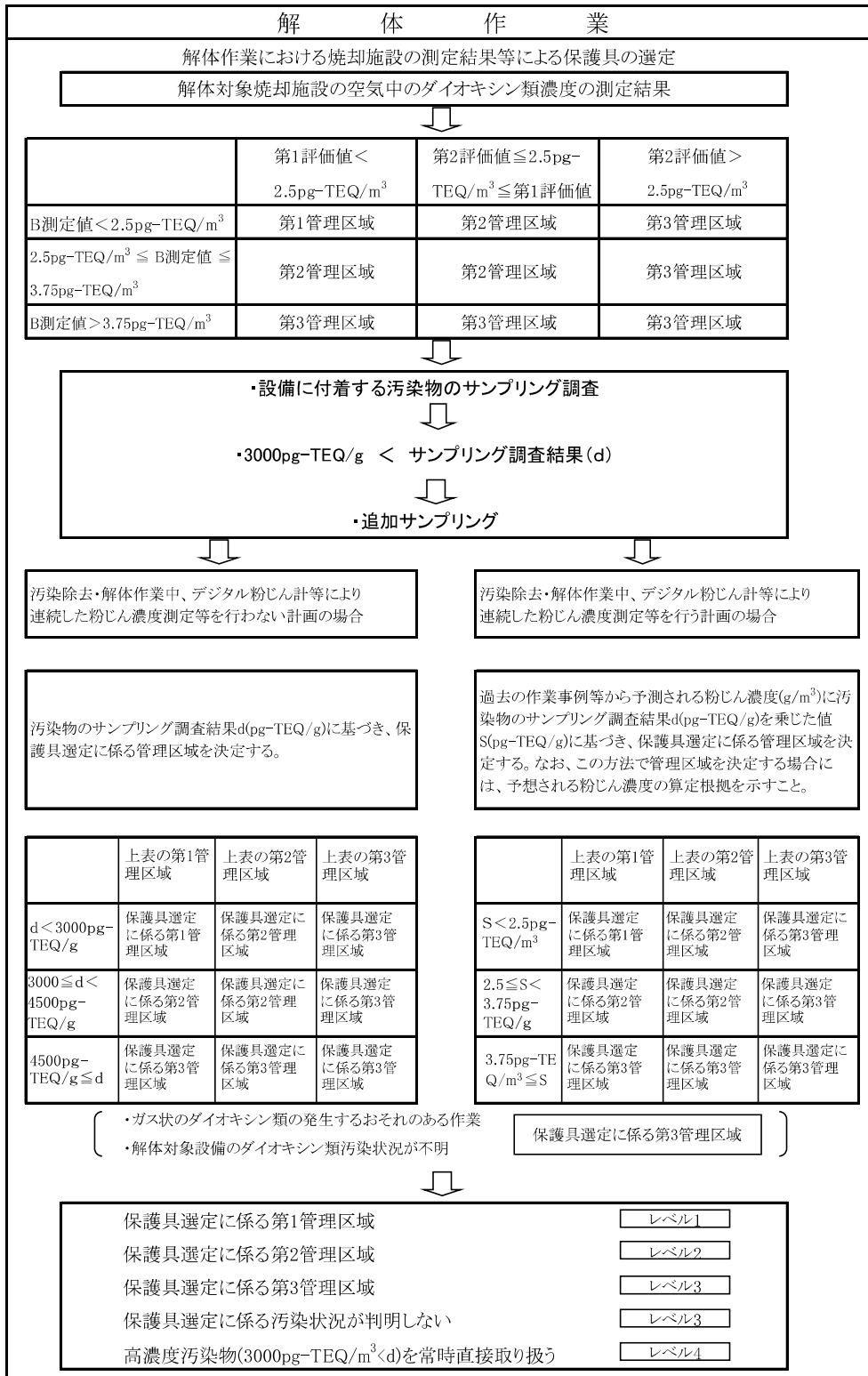
図 1 解体作業における測定結果等による保護具の選定
