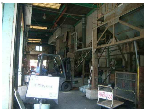
写真25 カレットコンベア ガラスビンを破碎してカレットにしている。
