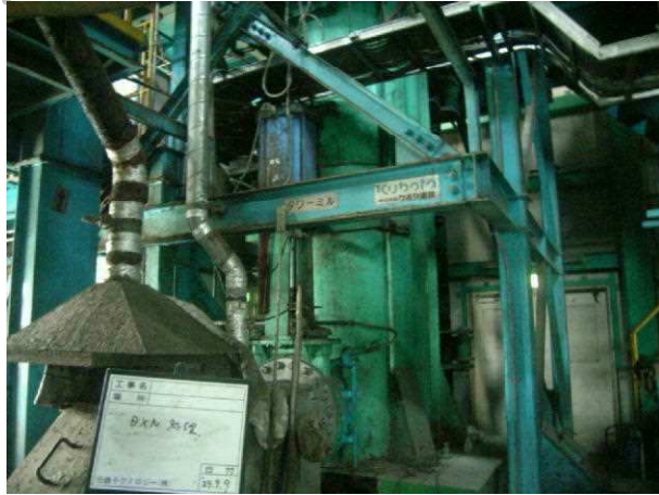
写真27 ダイオキシン処理プラント 脱ハロゲン反応機
