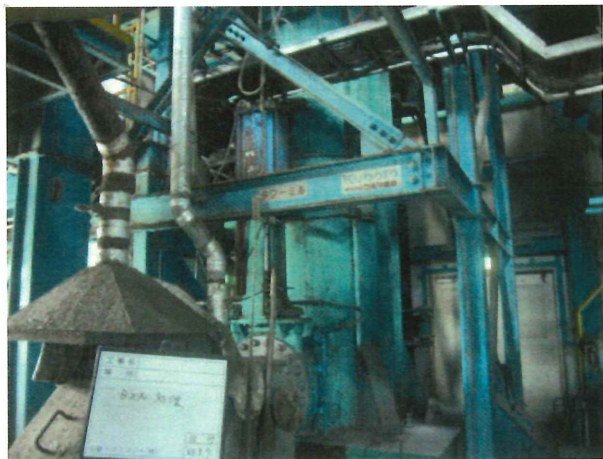
写真27 ダイオキシン処理プラント 脱ハロゲン反応機
