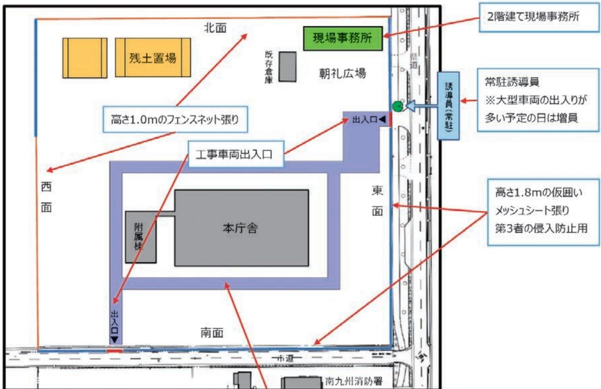
振動対策として大型重機の稼働する新庁舎建物廻りは敷き鉄板を敷く重機は低騒音型のもを使用
