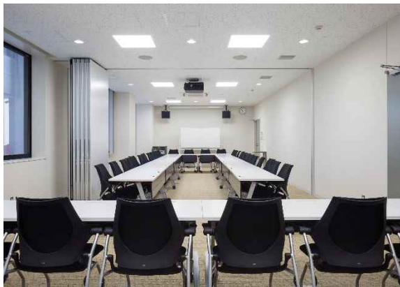
移動間仕切りのある会議室の事例(阿久比町庁舎)
