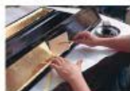
⑦箔・仕上げ 金箔を貼る・組み上げる。
