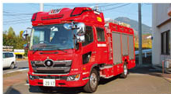
▲初期消火に必要な水 2,000ℓを積載し、さらに最新の機能（泡消火剤）を装備した消防自動車。
