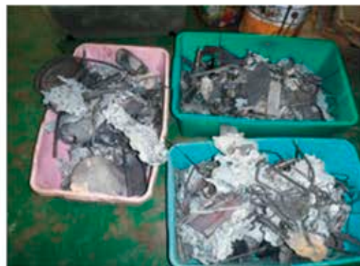
焼却炉内にあった鉄やアルミニウム
