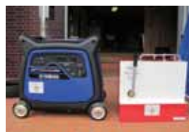
発電機と非常用無菌浄水機
